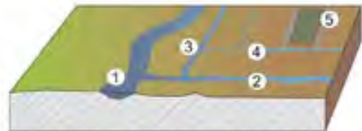
Fig. 11.6. Schematic view of the irrigation system: 1 distributeur , 2 partiteur , 3 arroseurs , 4 rigoles , 5 division des persels en bassins .
